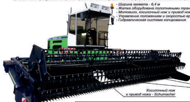
Плотные транспортеры могут находиться в 3-х положениях: для формирования валков по центру, влево или вправо
